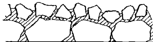
Rys. 3. Schematyczny obraz powierzchniowego utwardzenia nawierzchni typu „sandwich”
